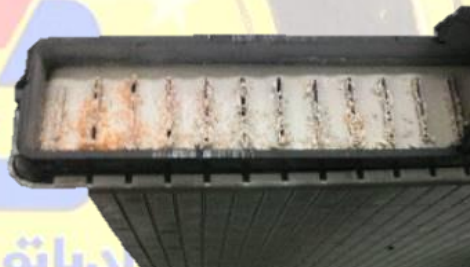
تشکیل رسوب به علت استفاده از آب رادیاتور غیراستاندارد یا نشت جریان برق به بدنه رادیاتور
