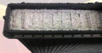
نمونه‌های مختلف از تشکیل رسوب
