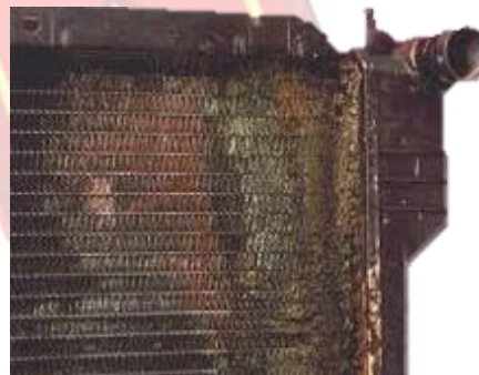
شبکه آسیب‌دیده در اثر خوردگی خارجی
