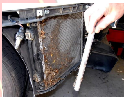
نمونه‌هایی از تجمع بیش از حد آلودگی محیطی بر سطح شبکه
