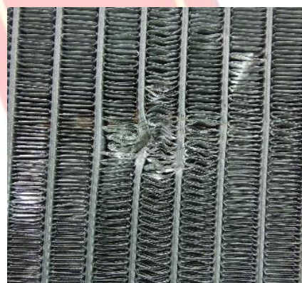
نمونه‌هایی از آسیب شبکه در اثر وارد شدن ضربه
