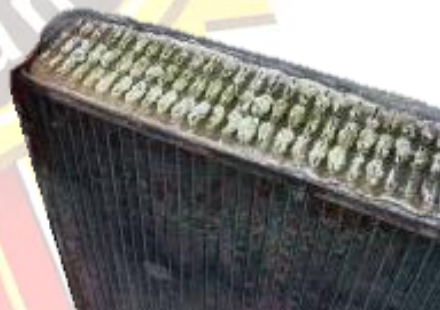
تشکیل رسوب به علت استفاده از آب رادیاتور غیراستاندارد یا نشت جریان برق به بدنه رادیاتور
