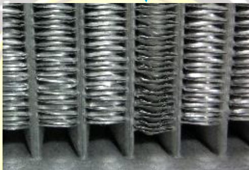
باد کردگی لوله‌های شبکه و له شدن پره‌ها به دلیل اعمال فشار غیر متعارف بر شبکه
