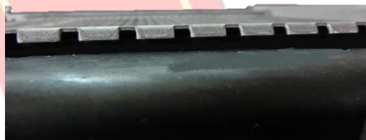
نمونه دیگری از باز شدن پرچ مخزن به دلیل ایجاد فشار غیرمتعارف بر شبکه
